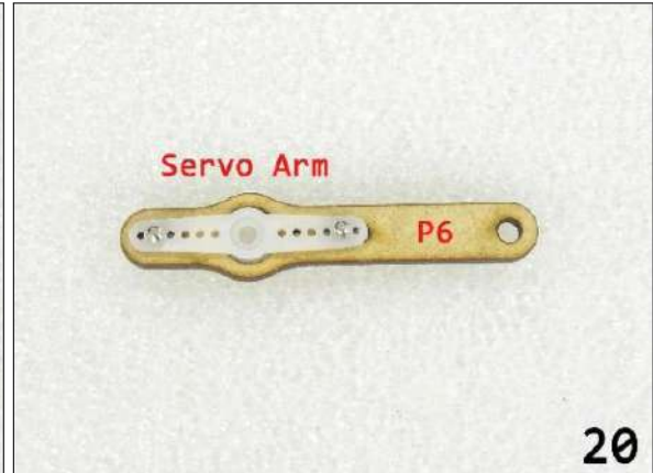
Figura 21 – Montagem do acoplamento do Motor Servo do movimento ombro: quarta parte do guia didático de montagem do motor em MDF.
