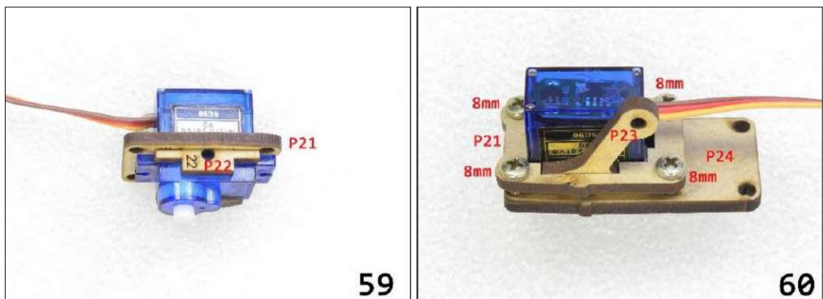
(e) Instalar as peças 22 (MDF) e 21 (MDF) ao Motor Servo. (f) Instalar peça 24 (MDF) a peça 21 (MDF) fixando os 4 parafusos de 8mm.
